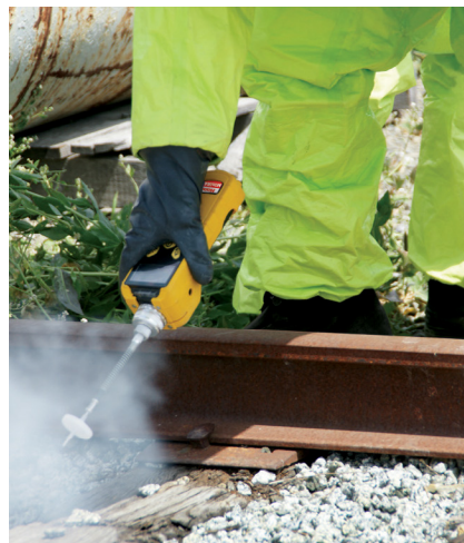
Быстрое измерение содержания летучих органических веществ и передача данных по беспроводной связи
