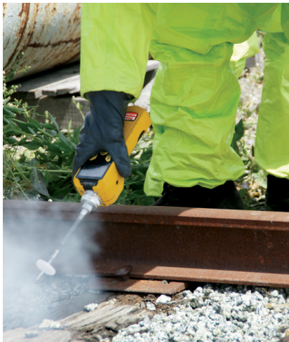
Los trabajadores pueden medir los COV rápidamente y transmitir los datos de manera inalámbrica
